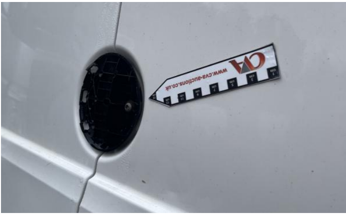
9: Fog Lamp osr Broken Replace
