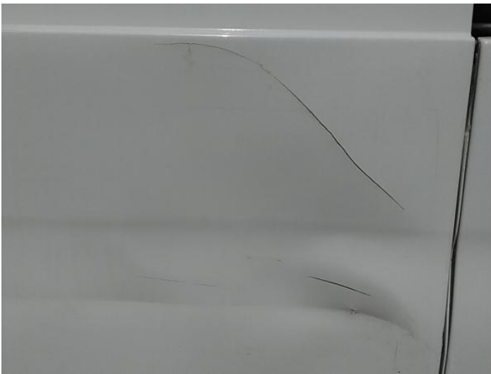
11: Door nsr Cracked Replace
