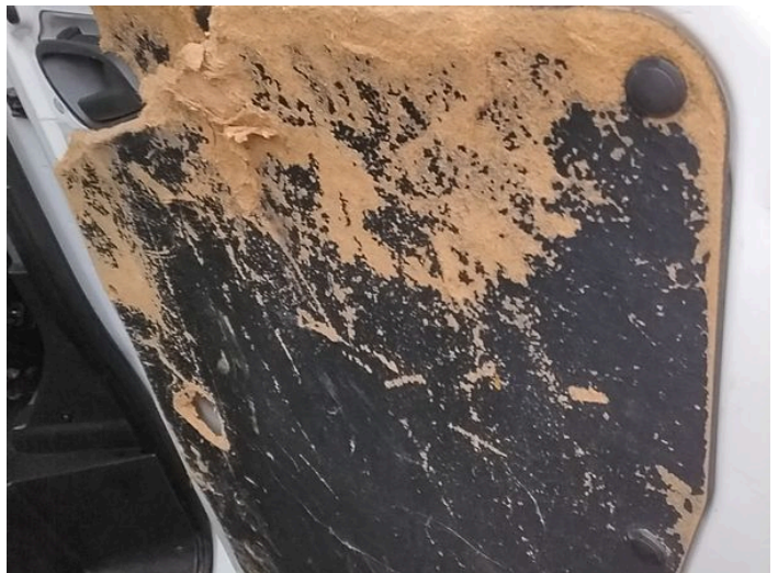
14: Door Pad osr Broken Replace
