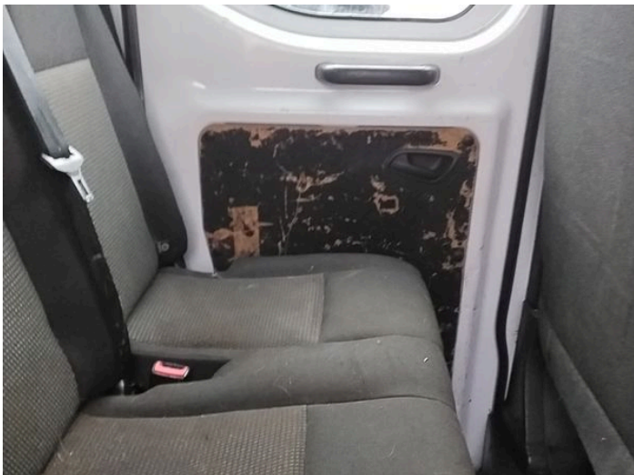
13: Door Pad nsr Broken Replace
