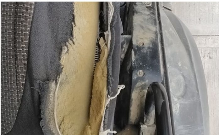
11: Door Pad osf Broken Replace
