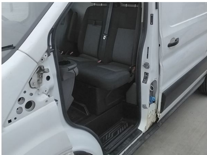
7: Door nsf Missing Replace
