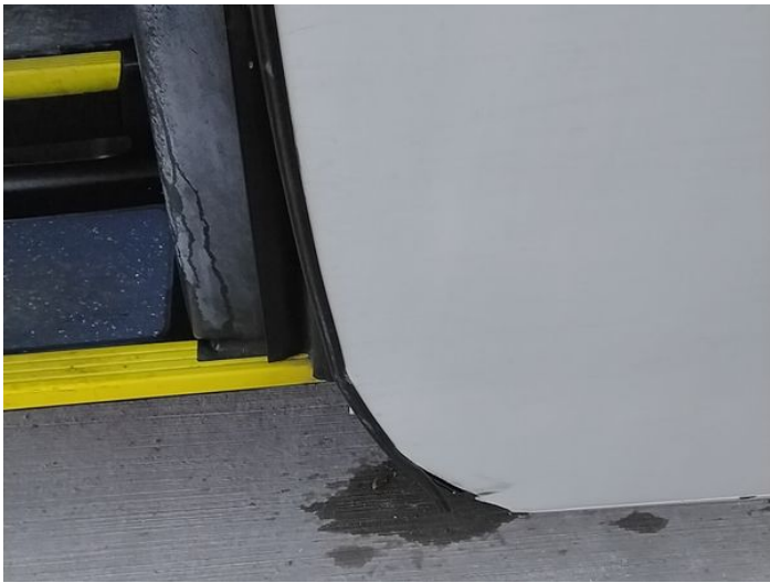
4: Door Moulding nsf Broken Replace
