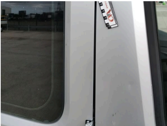
13: Door osr Chipped Edge Chip
