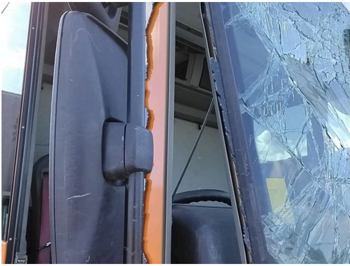
3: Door Qtr Light osf Missing Replace
