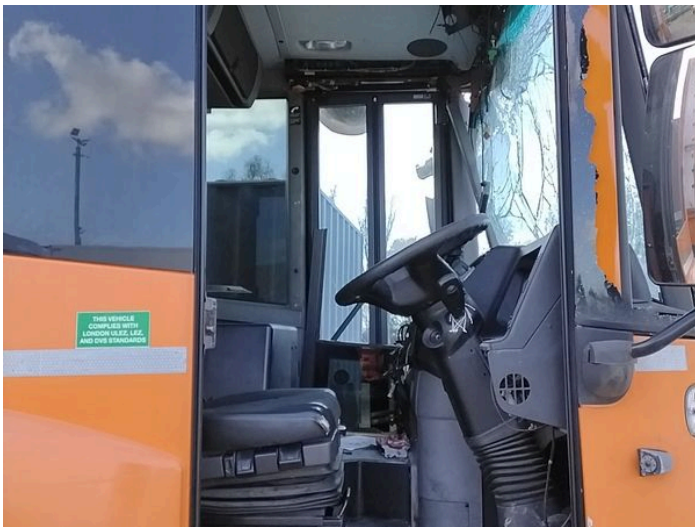
17: Door osf Missing Replace
