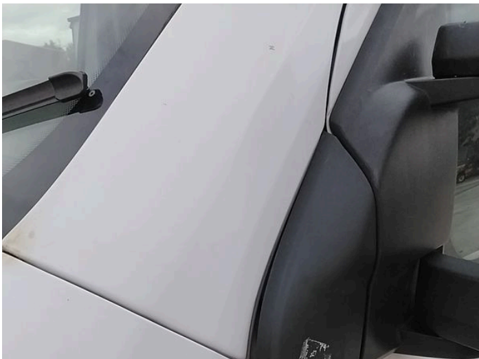
7: Door Moulding nsf Broken Replace
