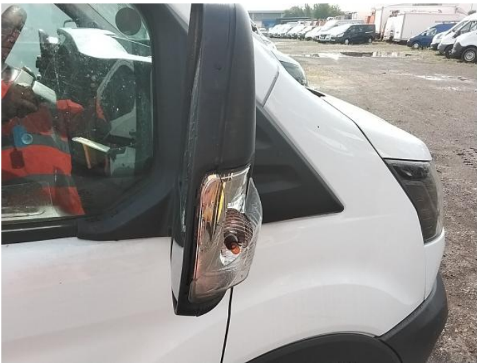
53: Door Mirror Assy osf Broken Replace
