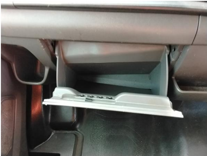
66: Glove Box Lid Broken Replace
