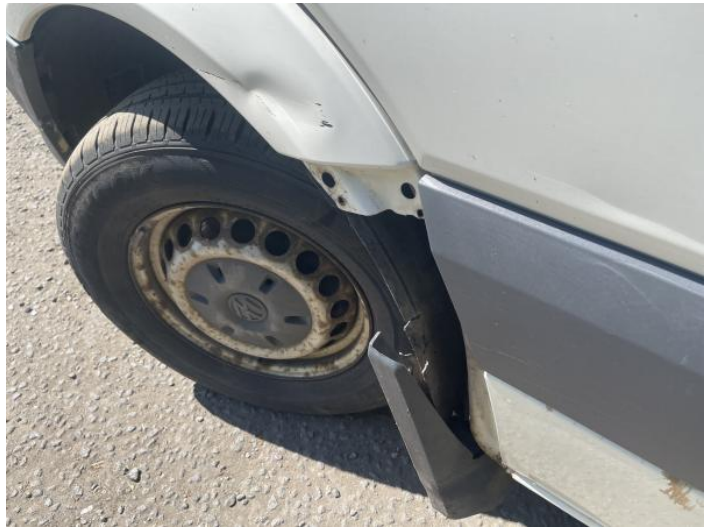
12: Door Moulding nsf Broken Replace
