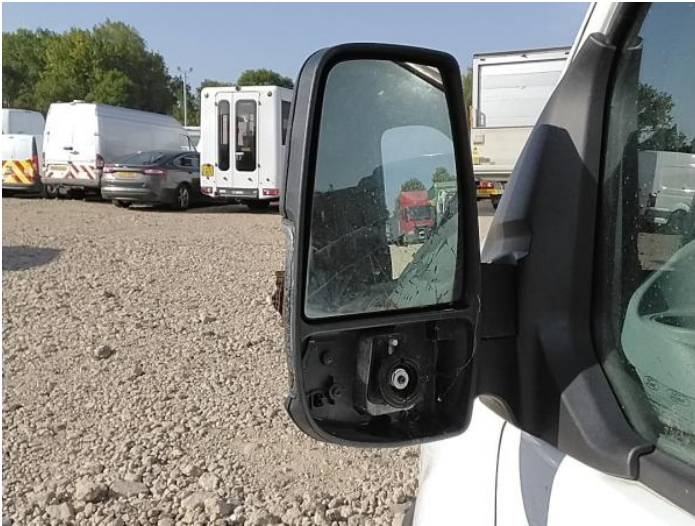
9: Door Mirror Glass ns Broken Replace
