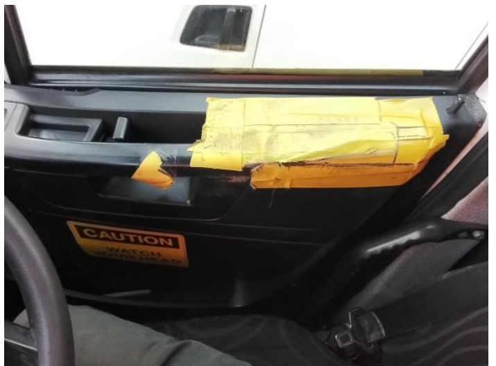
14: Door Pad osf Broken Replace
