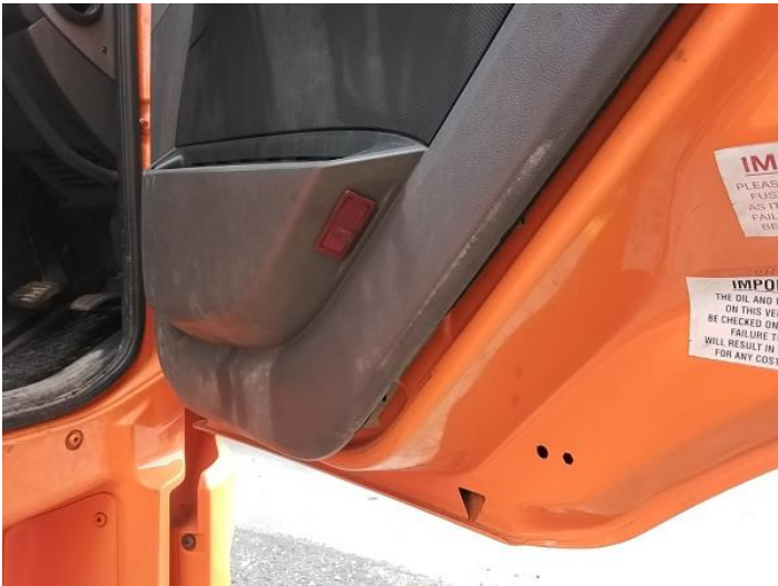
5: Door Pad osf Broken Replace
