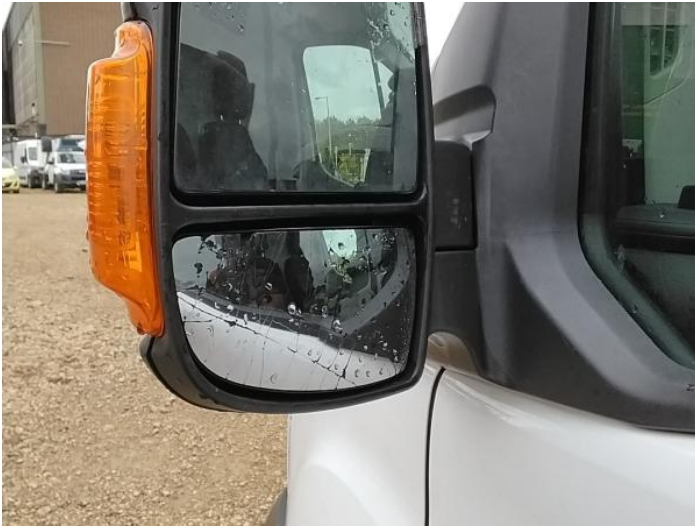
9: Door Mirror Glass ns Broken Replace
