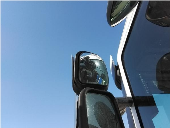
3: Door Mirror Glass ns Broken Replace
