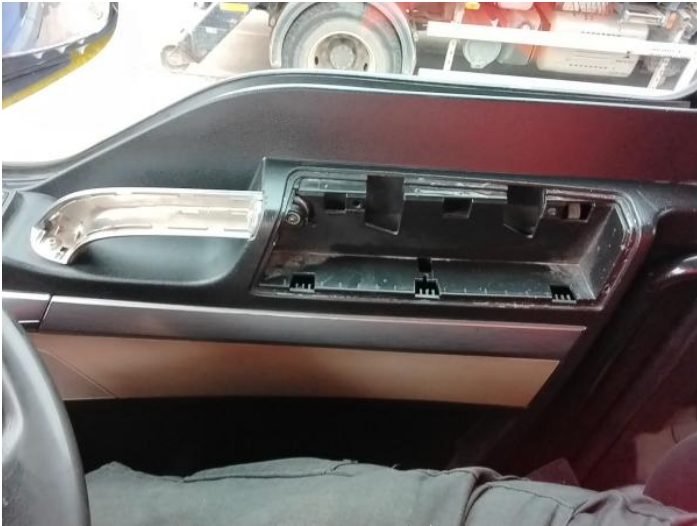
9: Door Pad osf Broken Replace
