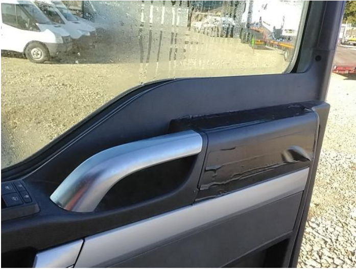
11: Door Pad osf Broken Replace
