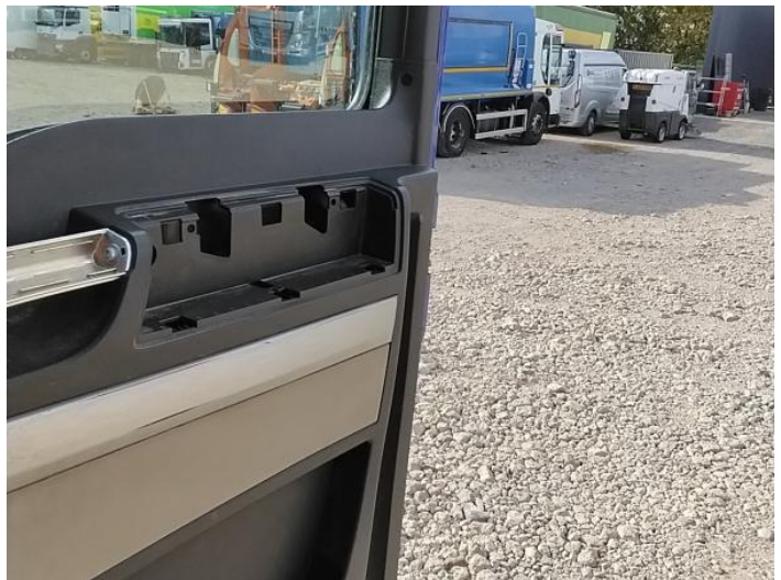
16: Door Pad osf Missing Replace
