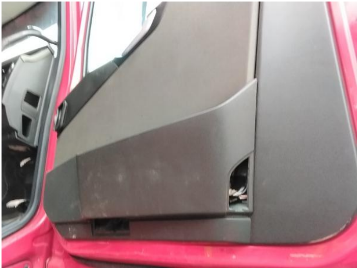
24: Door Pad osf Broken Replace
