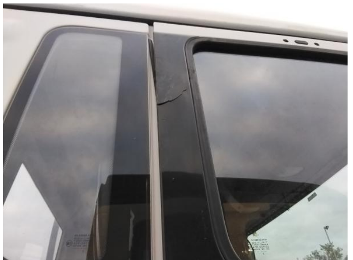
8: Door Moulding osf Broken Replace
