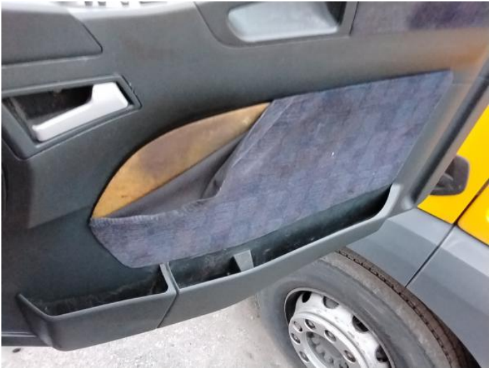
9: Door Pad osf Broken Replace
