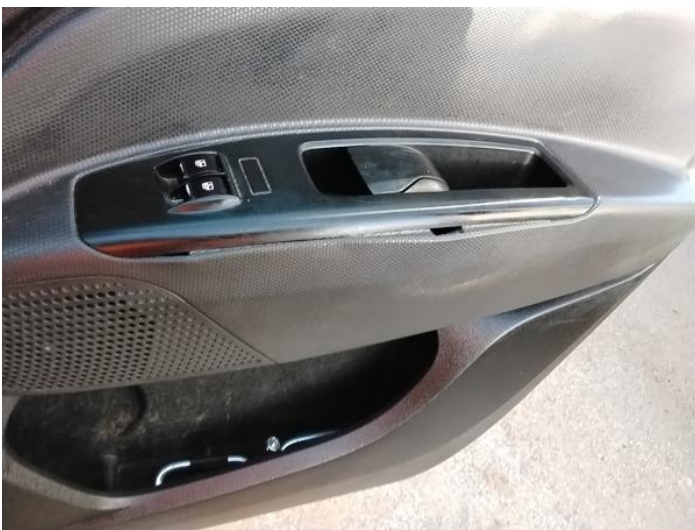
13: Door Pad osf Broken Replace
