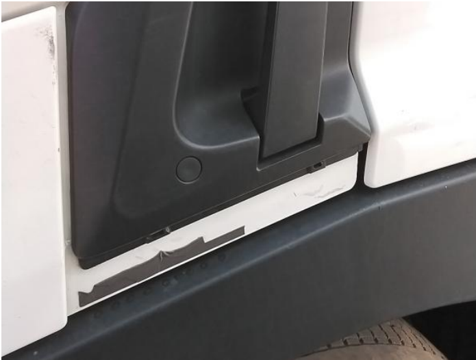
3: Door Lock osf Missing Replace
