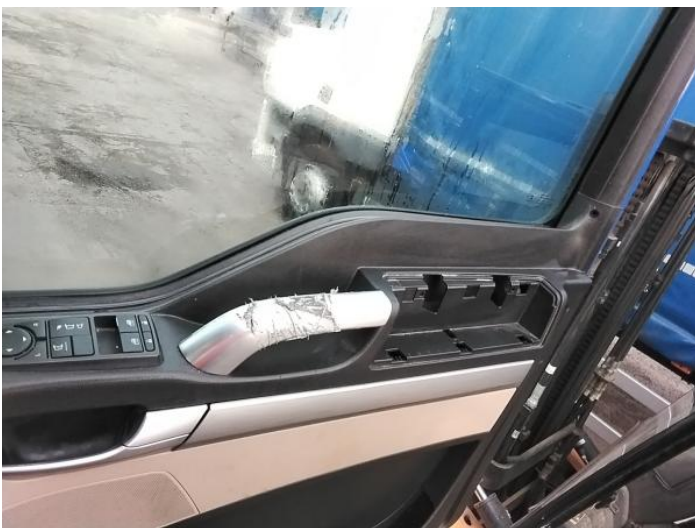
7: Door Pad osf Broken Replace
